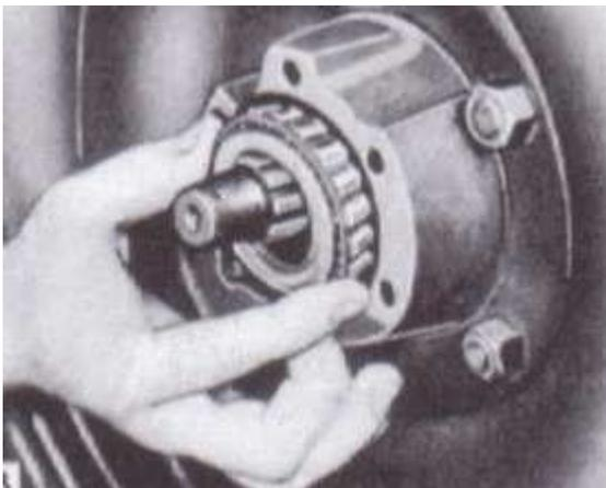
**Radlager:** Gehäuse und Lager gründlich reinigen, Lager und Lagerschale auf Verschleiss prüfen. Das Radlager mit Fett bestreichen, etwas Fett ins Gehäuse geben.
